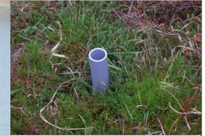
Le suivi des eaux du lac et de la tourbière est réalisé à l'aide de piézomètres installés dans la tourbière et dans le lac. Les données sont collectées régulièrement et permettent de suivre l'évolution des niveaux d'eau et de la qualité de l'eau.
