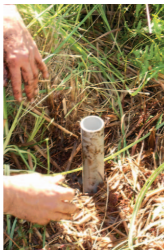
Ci contre : Un piézomètre installé cette année dans la tourbière.
